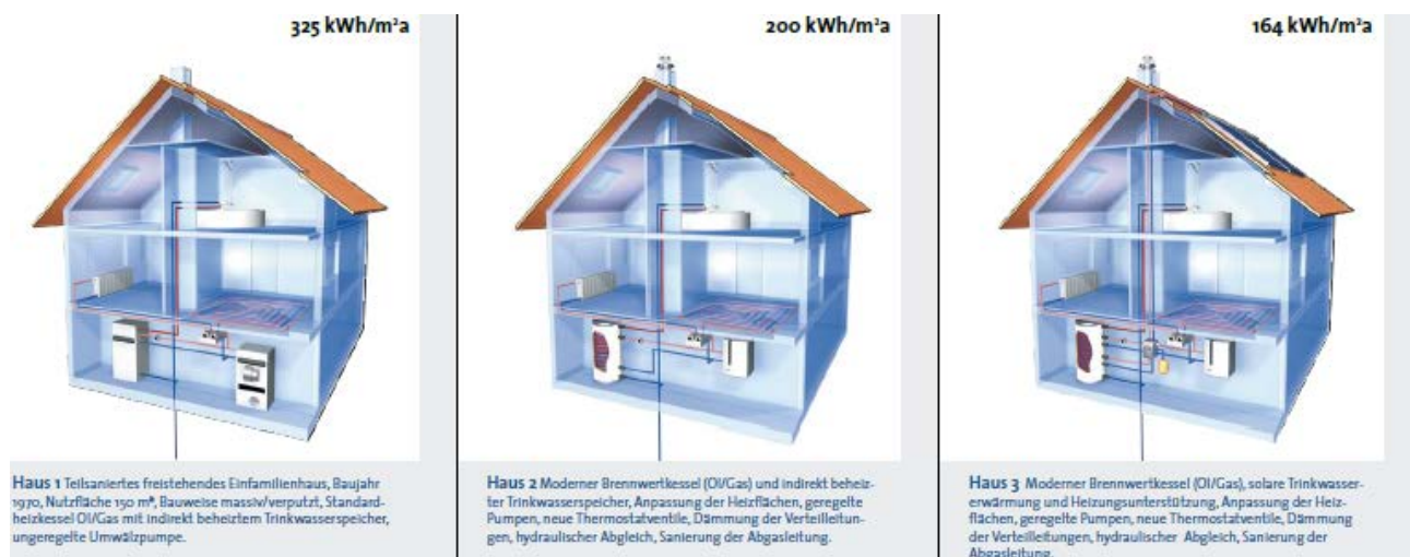
Abbildung 24: Potenziale der Nutzung effizienter Heiztechnik (BDH 2011)
